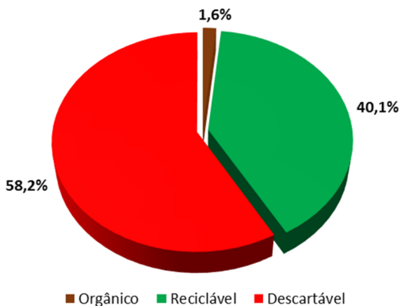
Figura 50 - Tipologia de rejeitos resultantes do processo de Triagem Composição dos Rejeitos da Central de Triagem
