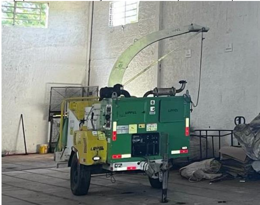
Figura 53 - Equipamento de trituração de resíduos de poda cedido pela ECOSERVICE
